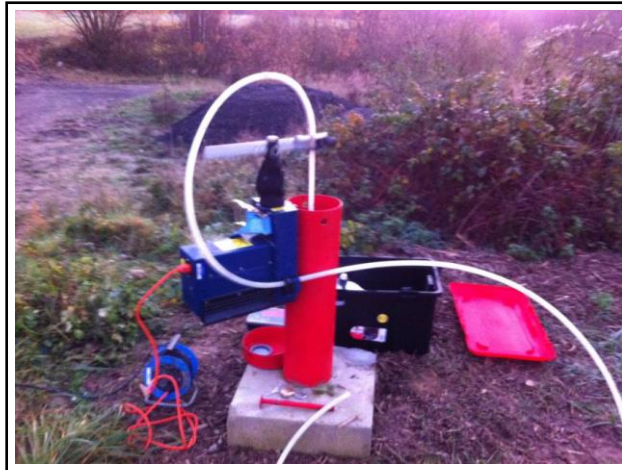
Prélèvement d'eau dans un piézomètre.
