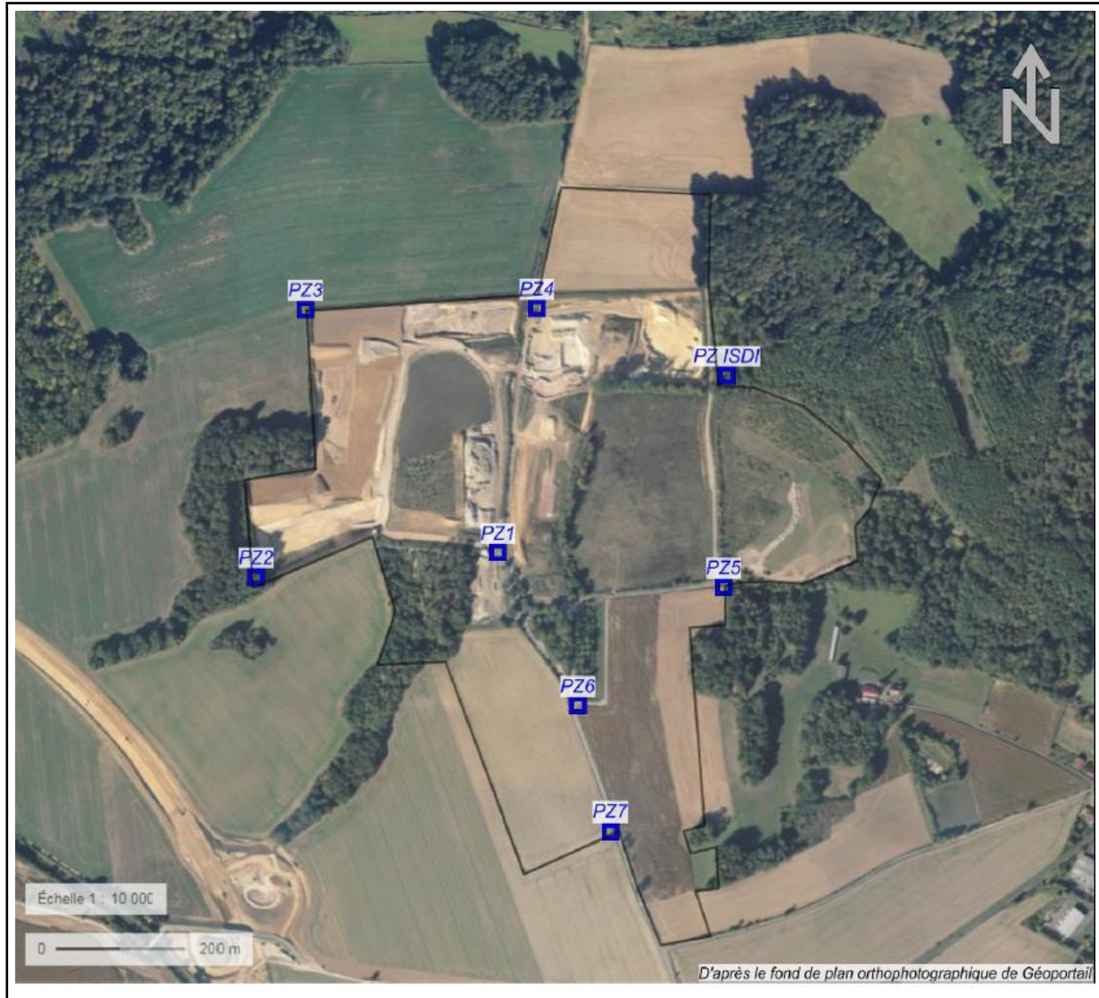
Réseau de contrôle piézométrique du site de Saint-Martin exploité par TERSEN
